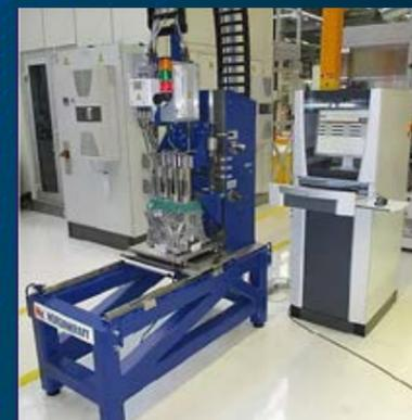
Основная область применения EMATEST-WMT - контроль толщин стенок гильз цилиндров, встраиваемых в камеры двигателей внутреннего сгорания. Измерительные головки, оснащенные ЭМА преобразователями, вводятся в блок цилиндров без физического контакта со стенкой гильзы и проводят измерения с микронной точностью.
