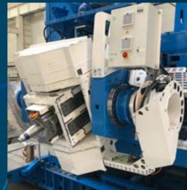
SONAFLEX-FSW это комплект инновационного дефектоскопического оборудования для ультразвукового контроля сварных швов, выполненных методом трения с перемешиванием. SONAFLEX-FSW разработан для обнаружения несплошностей и неоднородностей материала.
