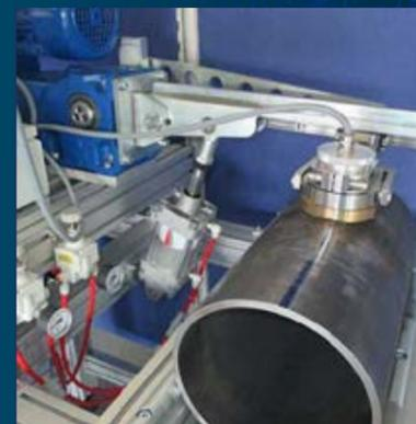
Комплект оборудования EMATEST-WSP предназначен для непрерывной оценки качества зачистки внутреннего грата сварного шва электросварных труб. Благодаря применению высокотемпературных бесконтактных ЭМА-преобразователей контроль осуществляется непосредственно в производственной линии клиента сразу после сварочного агрегата и гратоснимателя. Информация о качестве снятия грата необходима для контроля корректной настройки сварочного оборудования и поддержания высокого качества выпускаемой продукции.
